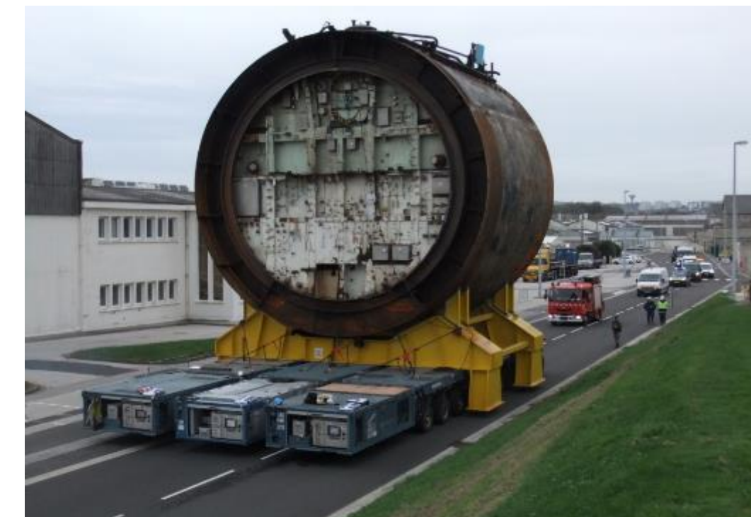
Tranche réacteur en mouvement (700 t portées par 3 chariots auto-moteurs)
